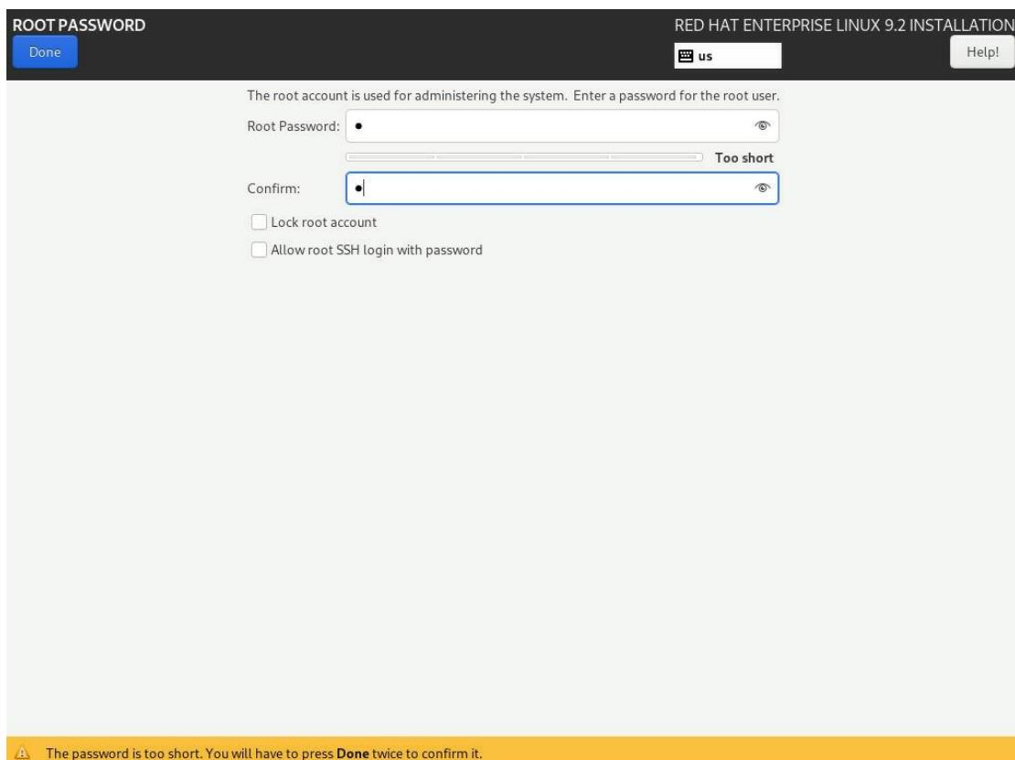
注：取消勾选 “Allow root SSH login with password” ，可使用 ssh 连接 root 用户。
