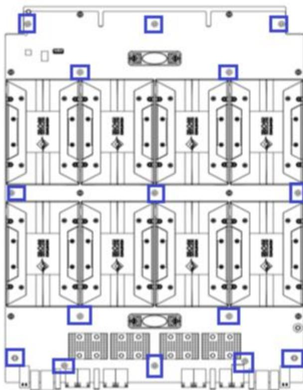
3. 将 UBB 模块的后面板安装到 UBB 插框的对应位置；
