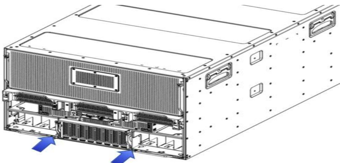
3. 向外同时转动两侧的扳手，使计算模块向外滑动；
