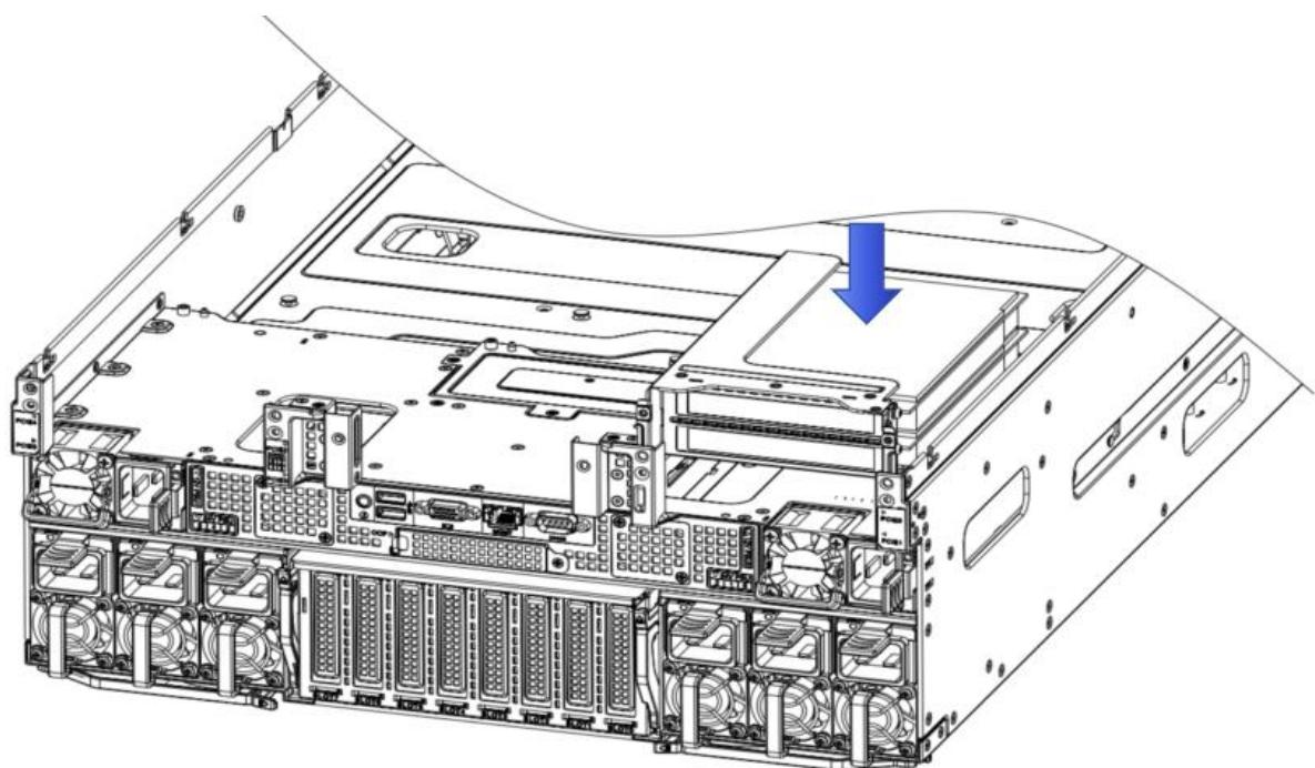
步骤 7. 用拆 PCIe 扩展模块保留下来的 2 颗螺钉将 PCIe 扩展模块锁紧到计算模块后面板上，再将尾部的松不脱螺钉锁紧；
