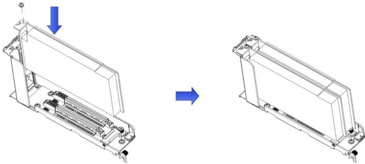
步骤 6. 将 PCIe 扩展模块调整好位置, 对准计算模块后面板上对应的凹槽缓慢放置安装到计算模块中;
