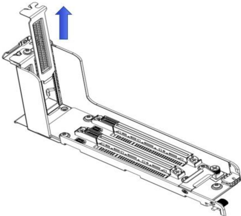
步骤 5. 将 PCIe 扩展卡插入到 PCIe 扩展模块对应的插槽中, 再用拆 PCIe 挡片保留下来的螺钉将螺丝锁紧固定;
