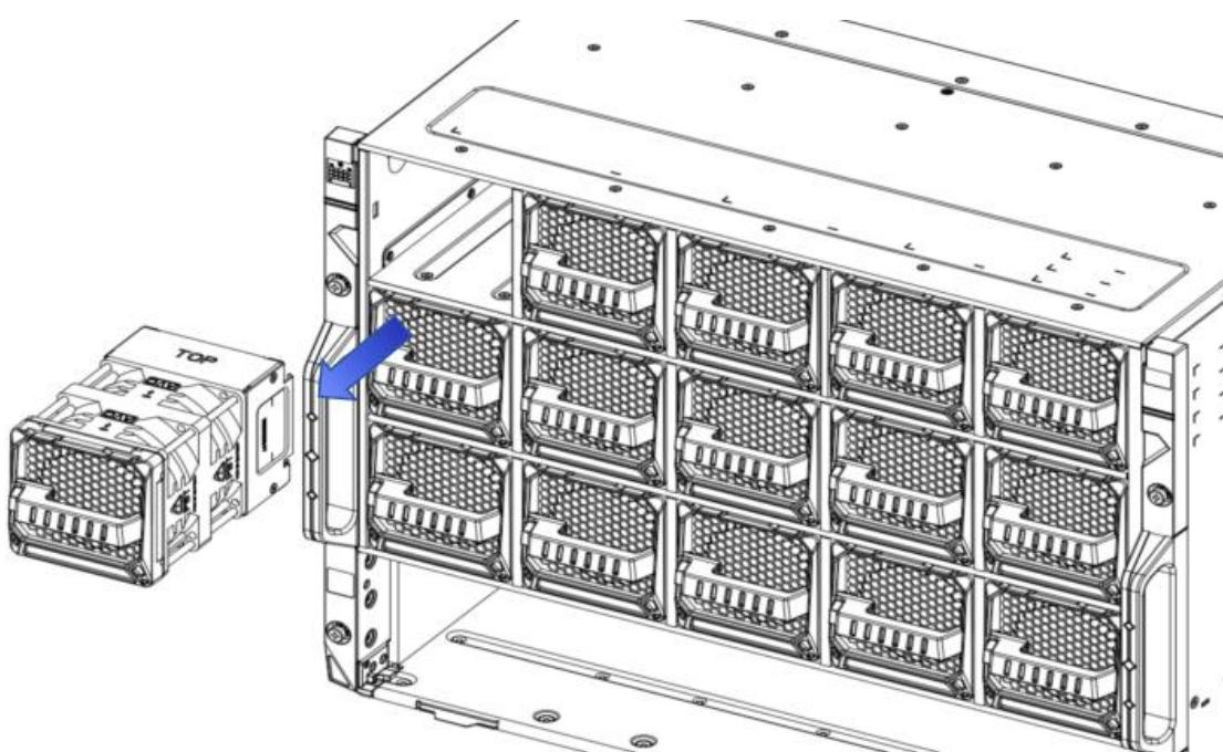
步骤 3. 依照步骤 1~2 方式完成剩下 14 个的风扇卸载.
