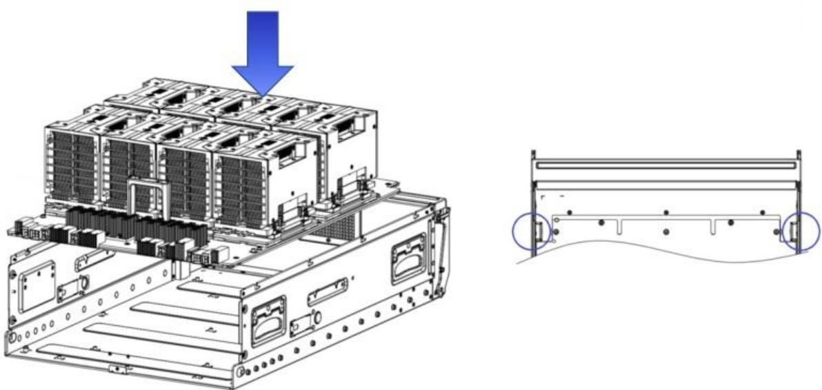
2. 用之前拆 UBB 板保留在来的 15 颗螺钉将 UBB 板锁紧固定；
