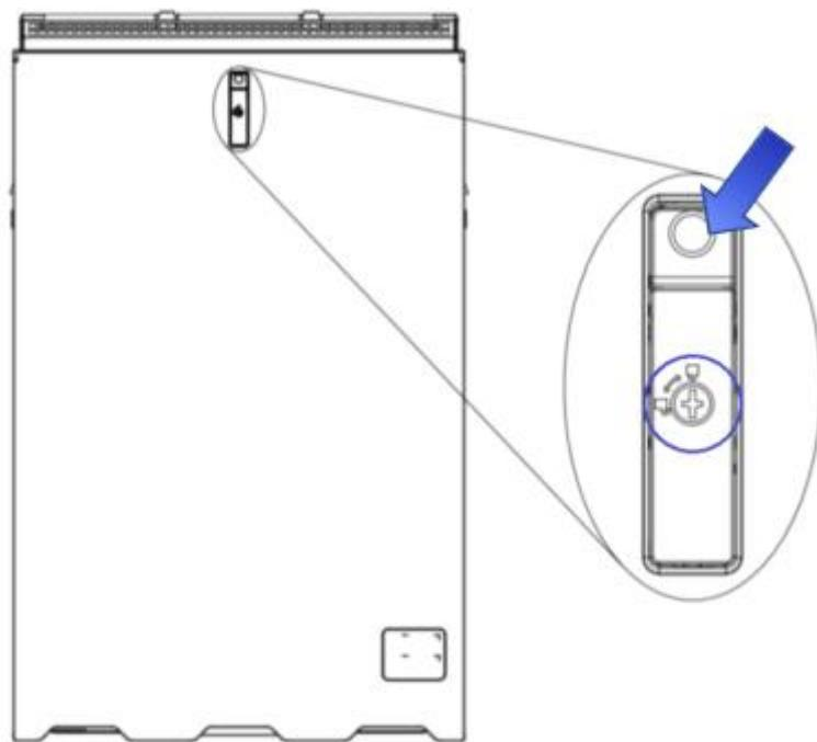
3. 旋转计算模块上盖上已弹起的扳手使其滑动;
