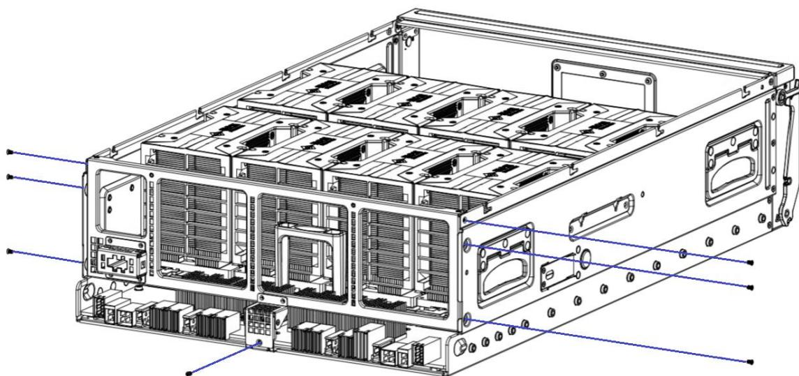
5. 将 UBB 模块上盖两侧的销钉对齐 UBB 插框两侧的凹槽放到 UBB 插框上, 再向前滑动, 直至无法滑动, UBB 模块上盖安装到位;
