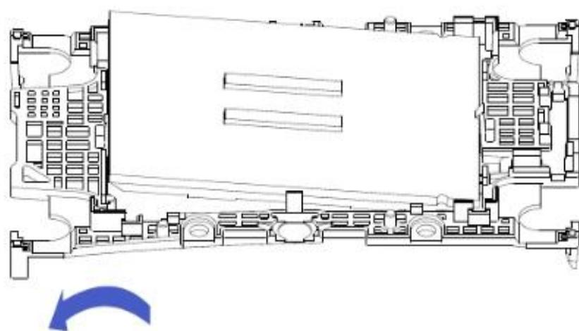
1-3. 松开夹持片，使夹持片另一端卡扣勾住 CPU 凹槽。
