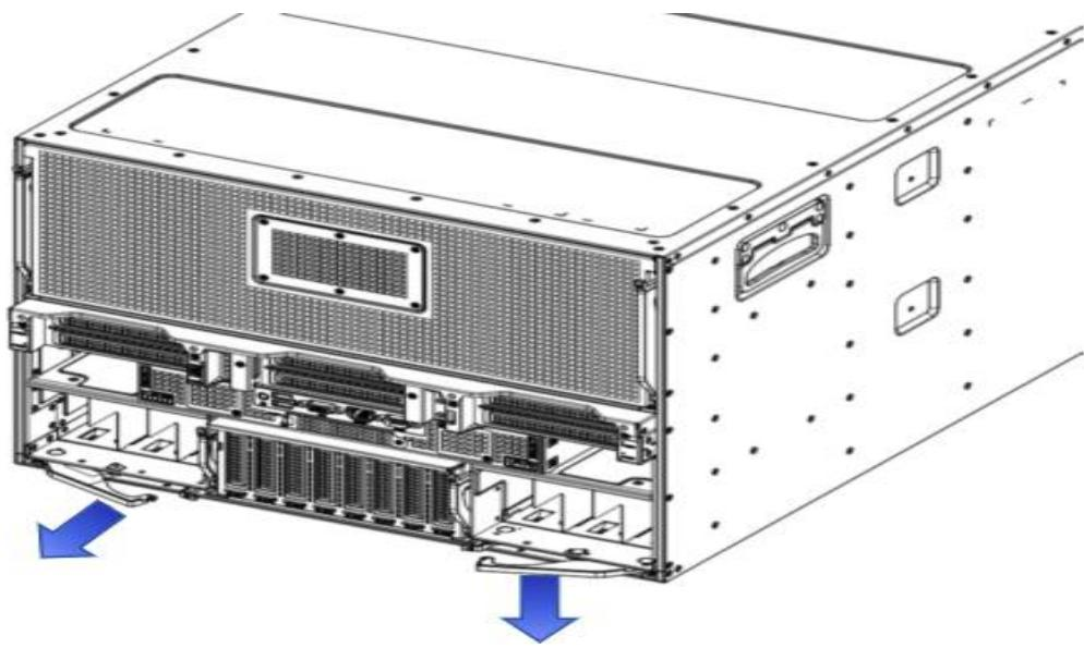
5. 当计算模块达到限位处无法向外抽动时，拖住计算模块底部，2 人同时按压计算模块两侧的限位弹片并向外缓慢抽出计算模块；
