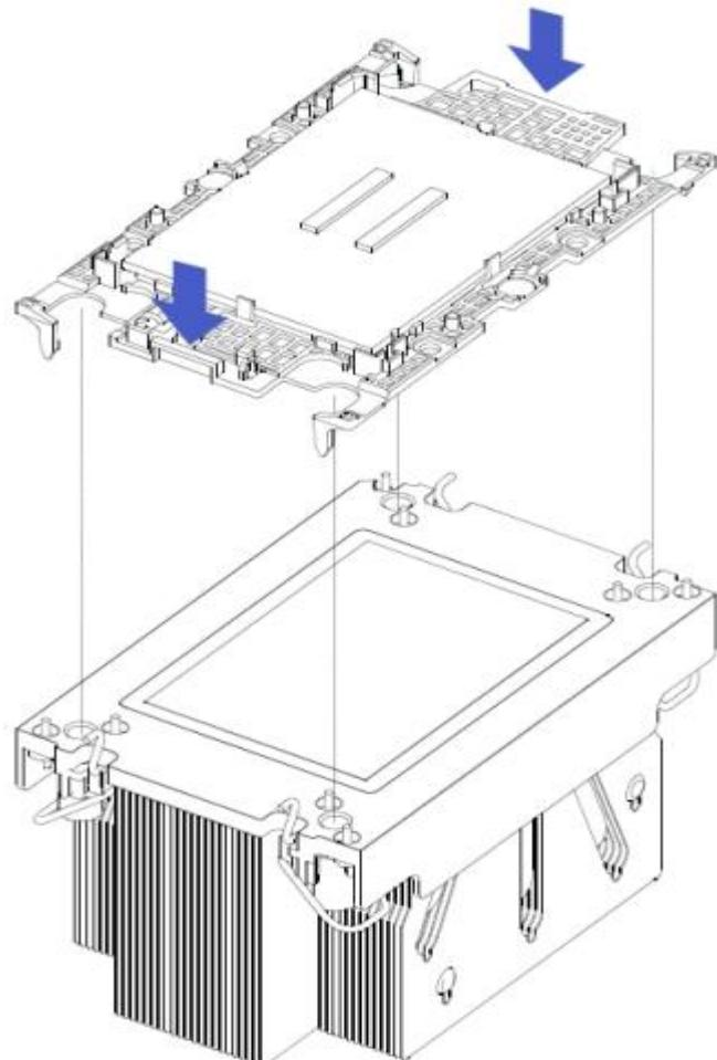
2-3. 仔细检查夹持片与散热器的安装情况，保证夹持片完全卡紧和平整。
