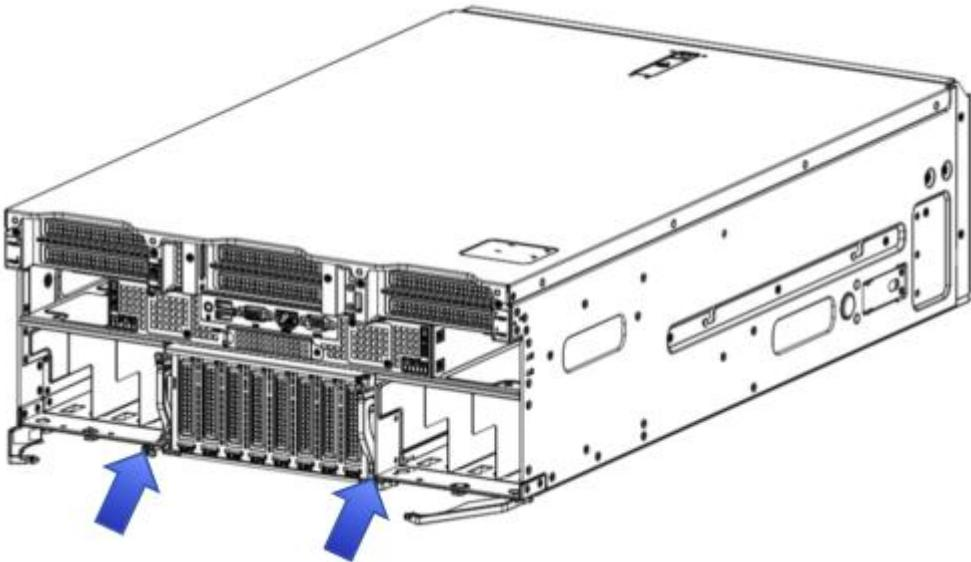
2. 由 2 人搬抬将计算模块插入到机箱并缓慢推入，直至无法推动，再向内同时缓慢旋转计算模块底部两侧的扳手；
