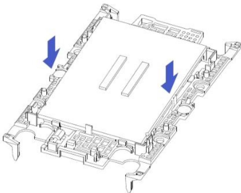
1-2. 沿箭头方向，弯曲压夹持片另一端，将 CPU 固定到夹持片上。
