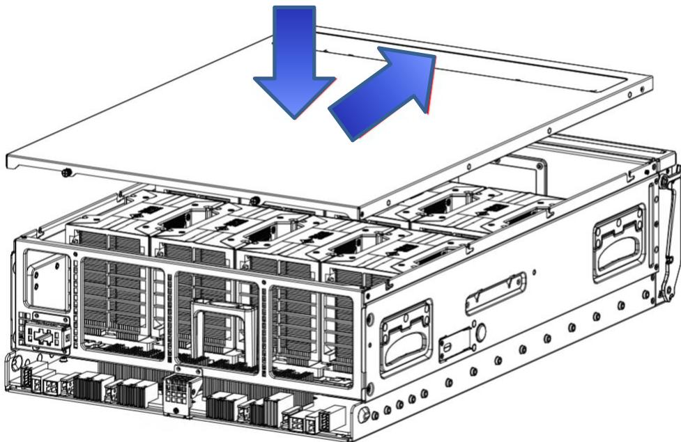
6. 用拆 UBB 模块上盖保留的 2 颗螺钉从两侧将 UBB 上盖锁紧,再将 UBB 模块上盖尾部的 2 颗松不脱螺钉用十字头螺丝刀拧紧;
