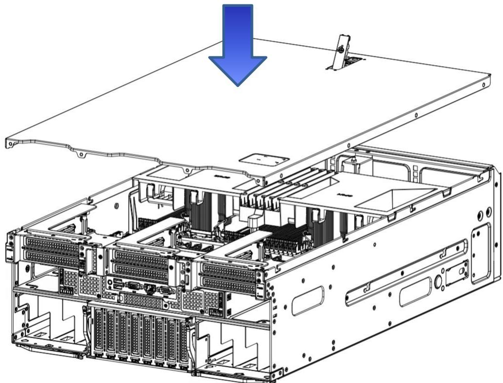
3. 旋转闭合计算模块上的扳手，计算模块上盖自动华东道闭合的位置；
