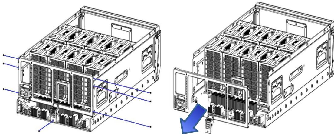
4. 拆下 UBB 板上的所有的螺丝，2 人分别用手握住 UBB 板上的 2 个提手，垂直向上取出 UBB 板放置在防静电桌子上；
