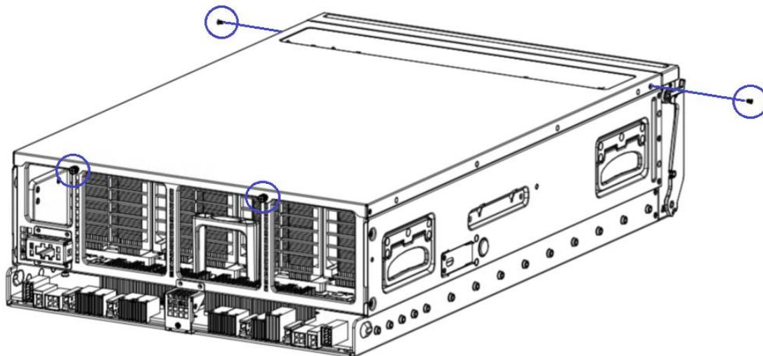
2. 将 UBB 模块上盖向后滑动，直至无法滑动，再将 UBB 模块上盖向上取出;
