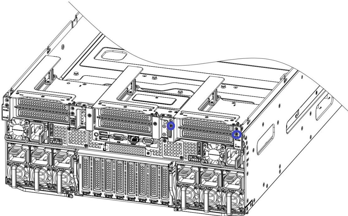
步骤 2. 用螺丝刀将 PCIe 扩展模块尾部松不脱螺钉拧松;
