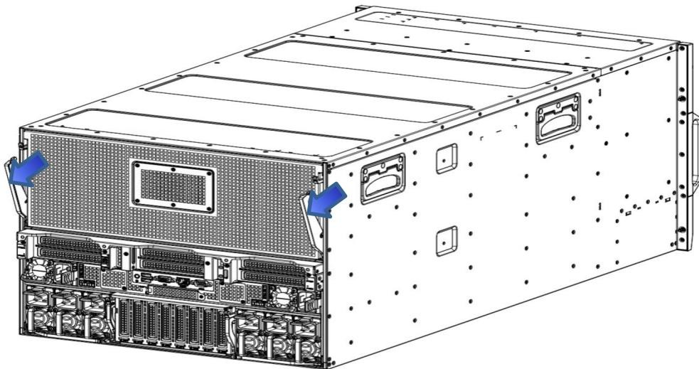
3. 向外同时转动两侧扳手，使 GPU 模块向外滑动；
