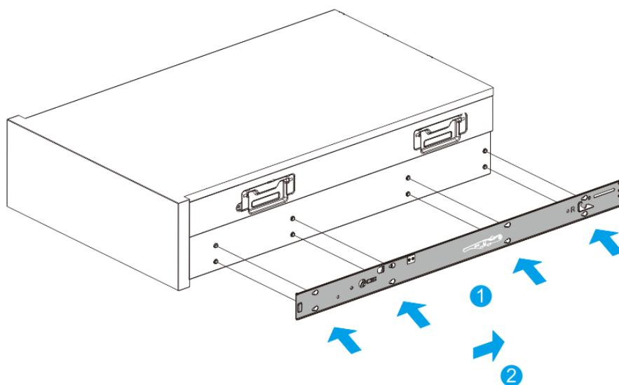
步骤 4. 安装服务器到机架中.
