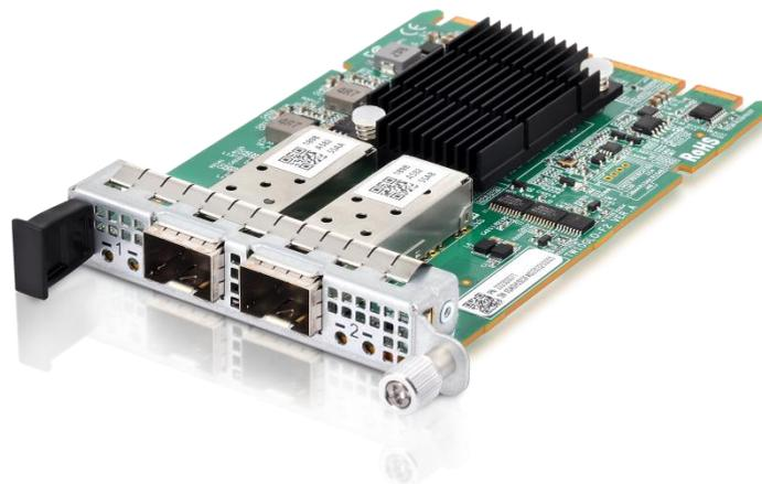
T710LO-F2 是同泰怡基于 Intel X710-BM2 芯片开发的万兆光纤以太网卡，为服务器和网络虚拟化提供了无与伦比的功能，兼容 LAN 和 SAN 网络的灵活性，以及可靠的性能，能够满足数据中心网络的苛刻需求。为通信、云和企业 IT 网络解决方案提供了广泛的互操作性、关键的性能优化和更高的灵活性。
