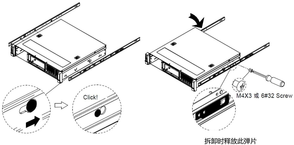
步骤 3. 安装外轨锁上机架
