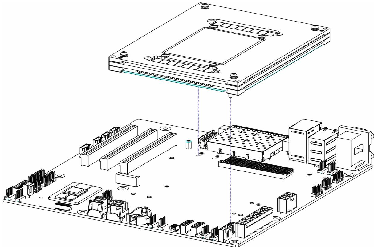
4-1. 用 4 颗十字槽盘头弹平垫组合螺钉 (GB/T9074.4 M3X20) 将模组固定锁紧到主板上。
