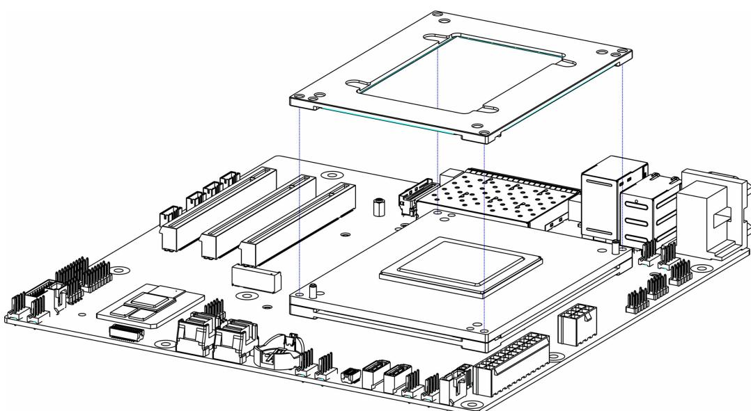
4-1.用 4 颗十字槽盘头弹平垫组合螺钉 (GB/T9074.4 M3X20) 将 KP920S 模组上支架组件固定锁紧。
