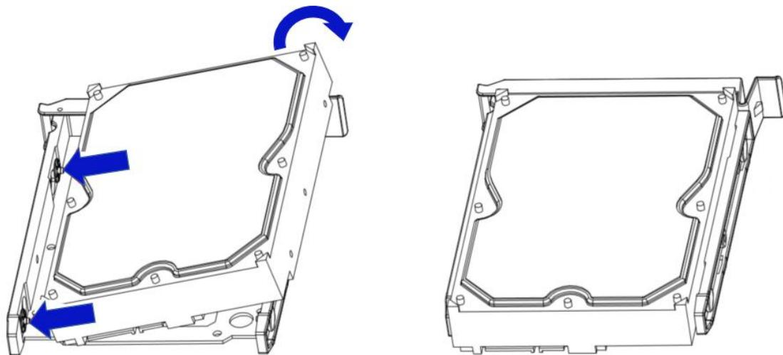
步骤 5. 将硬盘托架把手打开，将硬盘模块插入硬盘笼子中；
