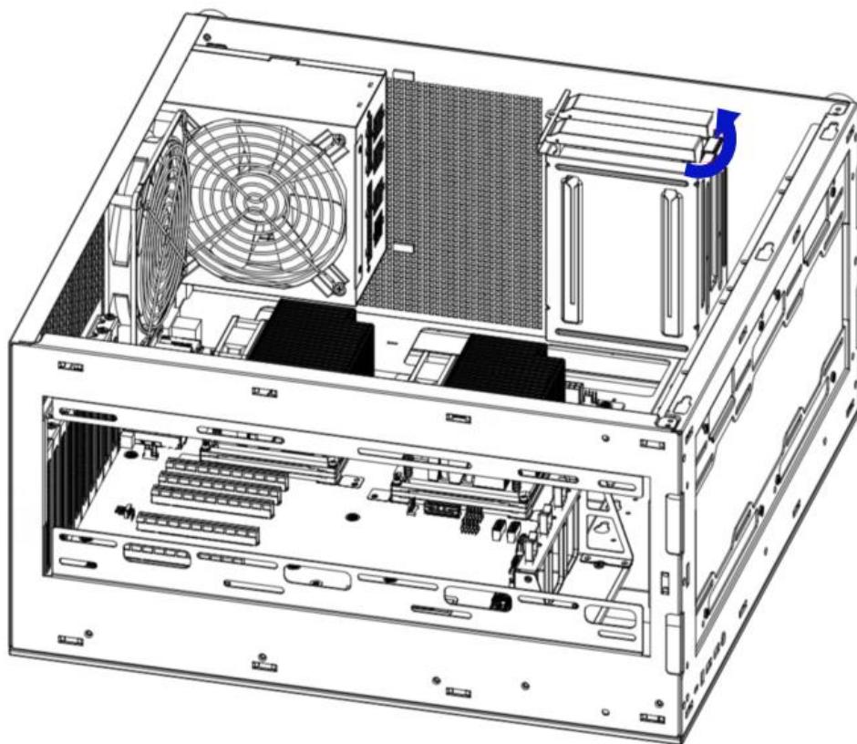
步骤 3、拉住硬盘托架的手柄向上取出硬盘模块。
