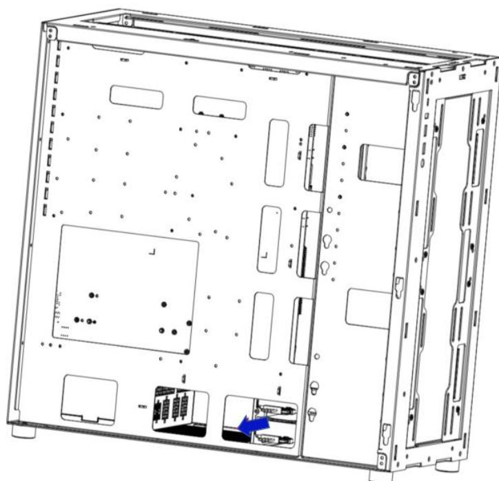
步骤 2、按压硬盘托架的卡扣并向上旋转；
