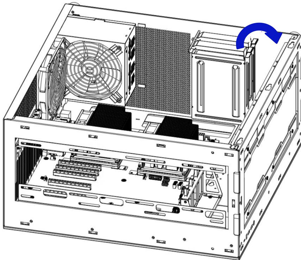
步骤 6. 将机箱翻转将硬盘信号线和硬盘电源线插入到硬盘
