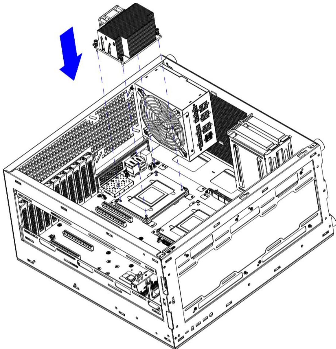
步骤 2. 按下图所示顺序依次锁紧散热器上的 4 颗弹簧螺丝，将风扇线插到主板上对应的连接器中；
