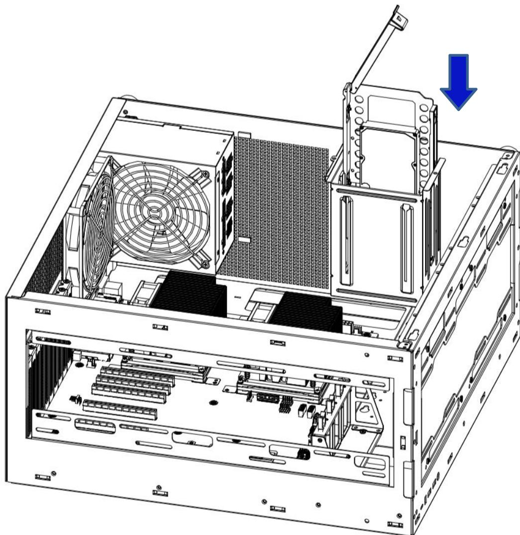
步骤 5. 硬盘模块插入到位后旋转硬盘托架把手使其关闭，听到“咔”声响后把手关闭完成；
