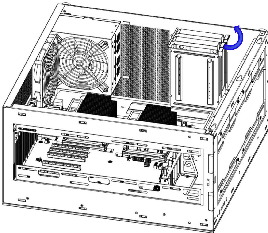
步骤 2. 拉住硬盘托架的手柄向上取出硬盘托盘；
