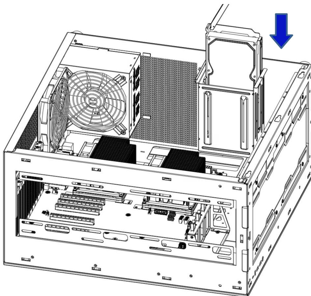
步骤 6. 硬盘模块插入到位后旋转硬盘托架把手使其关闭，听到“咔”声响后把手关闭完成；
