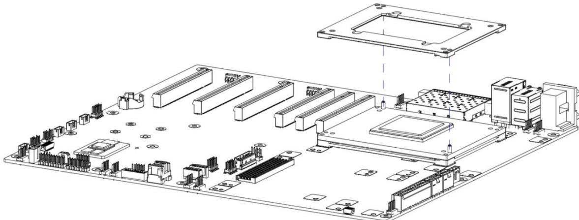
步骤 6. 用 4 颗十字槽盘头弹平垫组合螺钉(GB/T9074.4 M3X20)将 KP920S 模组上支架组件固定锁紧。
