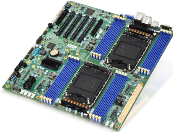
同泰怡 T3DE 双路 E-ATX 标准主板，基于第四代或第五代英特尔®至强®可扩展处理器构建，具备卓越的计算性能、丰富的 I/O 接口和超高的性价比，适用于云计算、虚拟化、分布式存储、超融合等应用。
