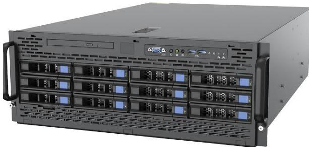
TG556V1-Q 是同泰怡自研的一款塔式 AI 服务器/一体机产品，支持两颗鲲鹏 920-Smart 模组，支持 4 个双完全尺寸 GPU 卡超强 AI 算力基于优异的风道散热设计，支持各类推理卡及训练卡，尤其适合 AI 推理、模型微调、本地知识库搭建、HPC、仿真渲染等应用场景。
