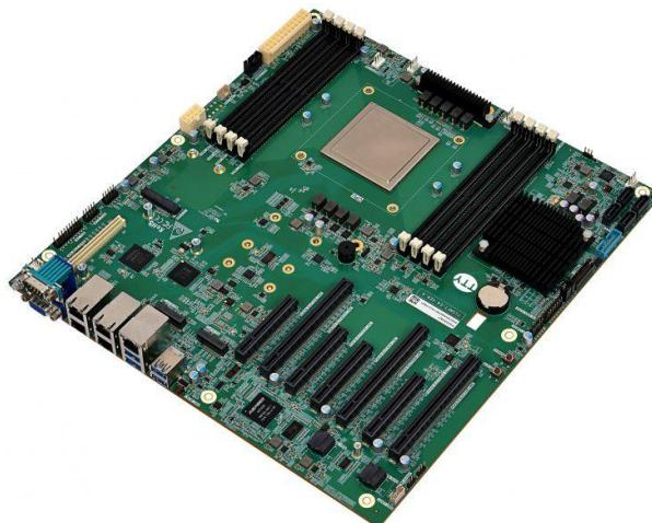
T1SMFT-E4 主板是同泰怡基于飞腾 FT-2000+/64 CPU 平台开发，一款面向高性能计算和高端服务器的 64 核处理器 EEB 双路主板，是国内满足自主可控的 ARMV8 架构产品，整体性能优异，支持国产固件和安全可信模块，保护用户私密数据信息，既可满足政府机构及党政部门系统的需求，也可轻松应对各种场景应用。
