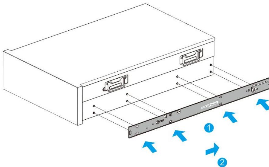
步骤 4.安装服务器到机架中.
