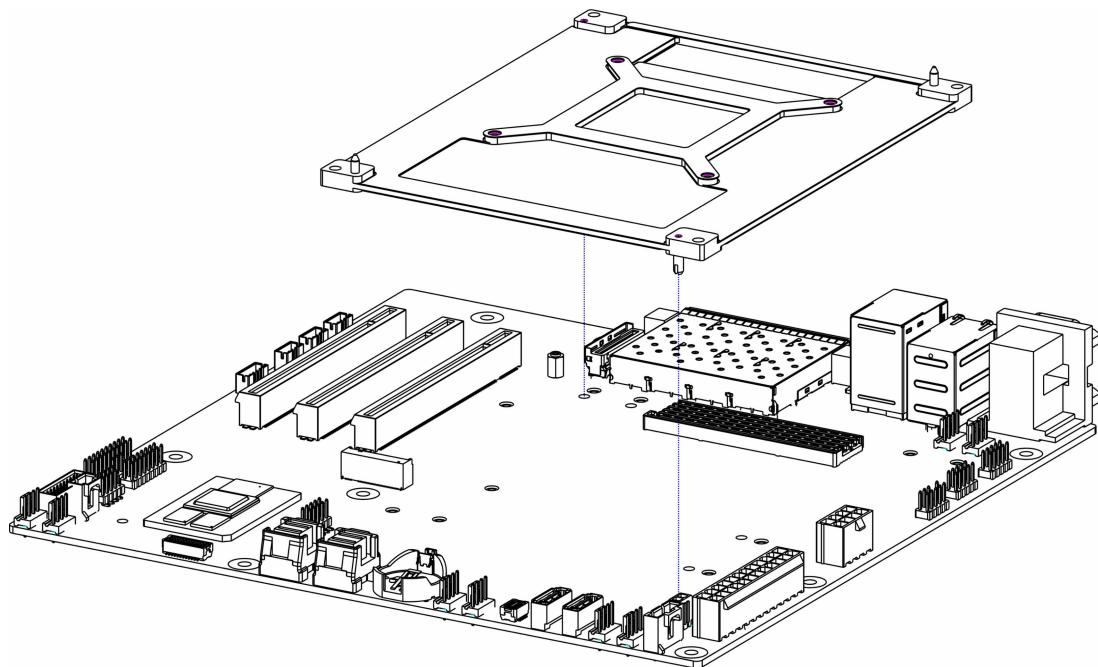
2-1. 将 KP920L CPU 模组调整好位置，使 2 个定位孔和连接器与 KP920L 模组支架上的 2 个定位销钉和主板上的连接器对准，将 KP920L 模组水平缓慢按压插入到主板上；
